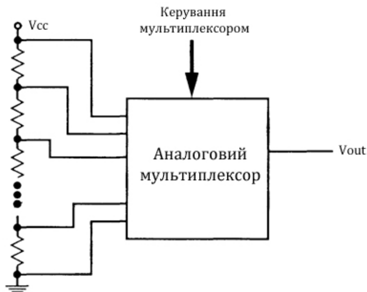
Рис. 4.7. Отримання опорних напруг за допомогою резистивного дільника
