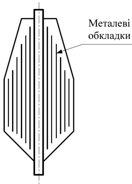
Рис. 8.5. Ескіз прохідного ізолятора конденсаторного типу
