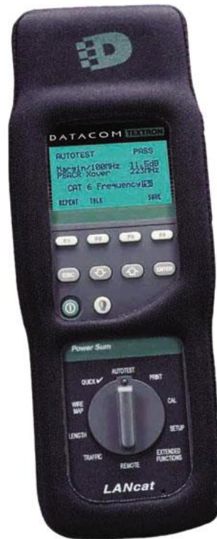
Рисунок 10.6 – Кабельний тестер Greenlee (Datacom) LANcat System6
