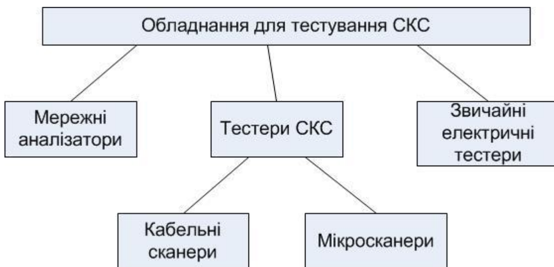
Рисунок 10.1 – Обладнання для тестування підсистем СКС
