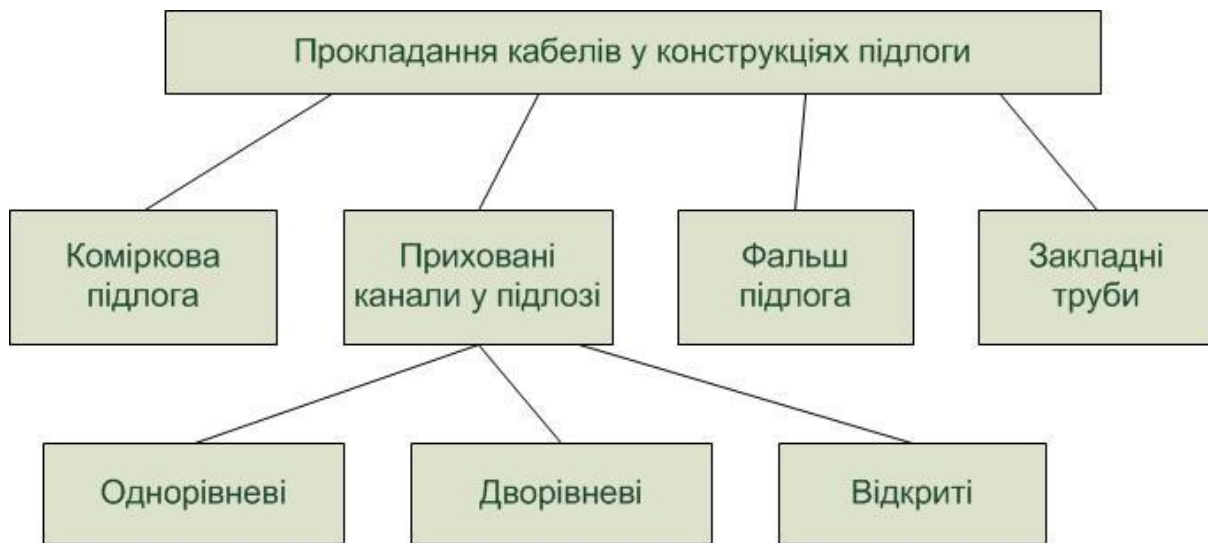
Рисунок 7.4 – Варіанти організації кабельних трас при прокладанні кабелів у конструкціях підлоги
