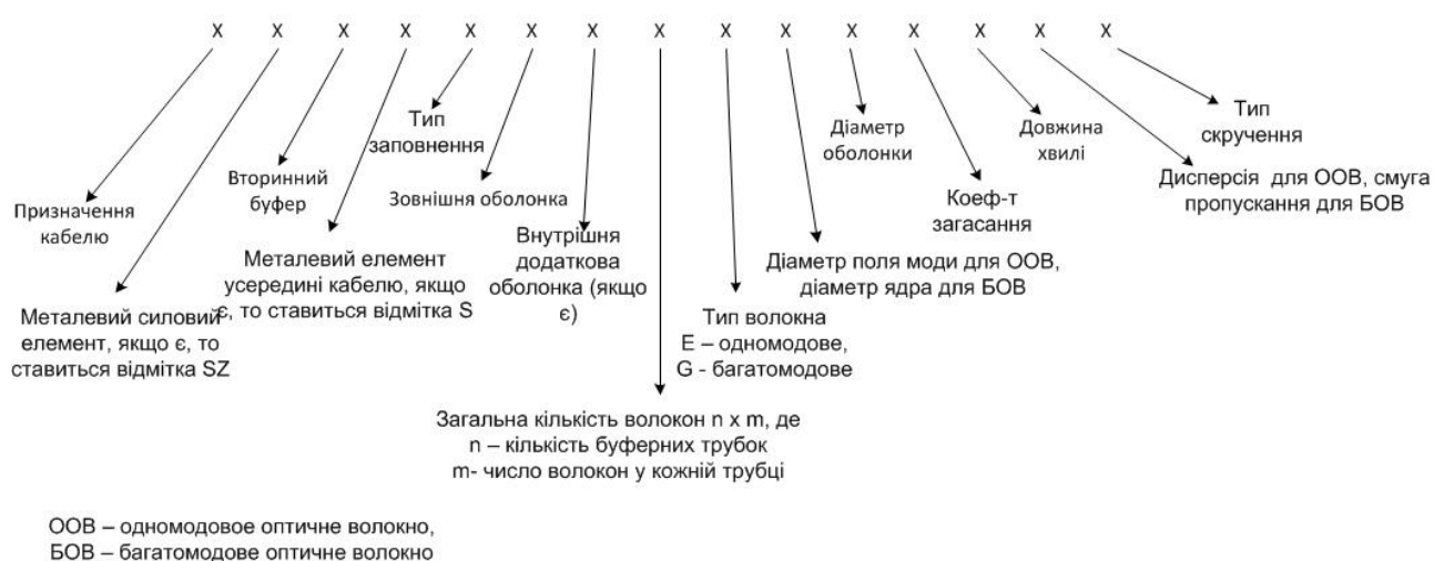
Рисунок 4.2 – Маркування оптичних кабелів
