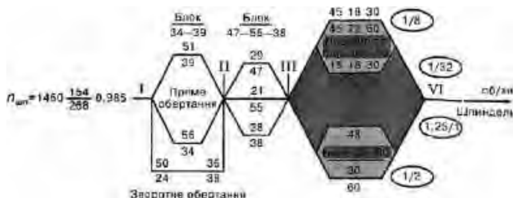
Рис. 10.15. СТРУКТУРНА СХЕМА КОРОБКИ ШВИДКОСТЕЙ ВЕРСТАТА 16К20 (ПОЗНАЧЕННЯ ВАЛІВ ДИВ. НА РИС. 10.13)
