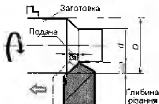
Рис. 1.14. ПОДАЧА s , мм/об, ТА ГЛИБИНА РІЗАННЯ t , мм
