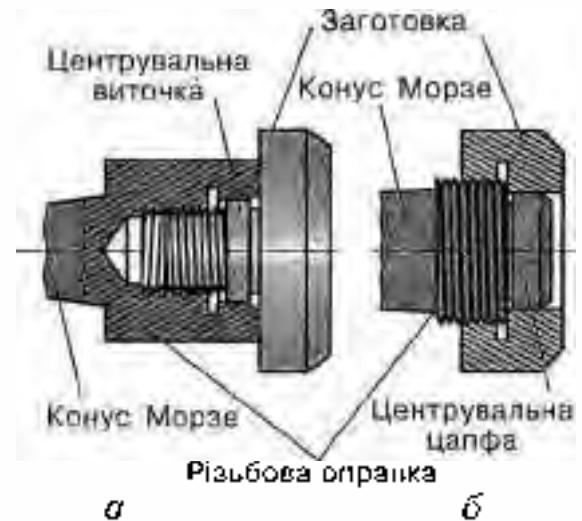
Рис. 13.9. Базування заготовки на різьбовій оправці:
