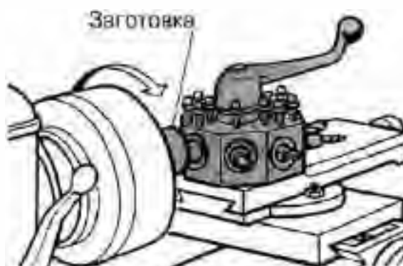
Рис. 14.16. РЕВОЛЬВЕРНИЙ РІЗЦЕТРИМАЧ ДЛЯ ТОКАРНОГО ВЕРСТАТА
