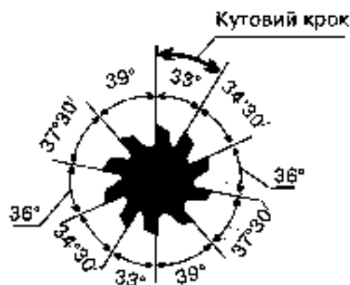
Рис. 3.35. НЕРІВНОМІРНИЙ ЦЕНТРАЛЬНИЙ КУТ РОЗВЕРТКИ
