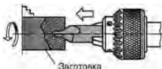
Рис. 3.40. ЦЕНТРУВАННЯ ЗАГОТОВКИ ВАЛА НА ТОКАРНОМУ ВЕРСТАТІ
