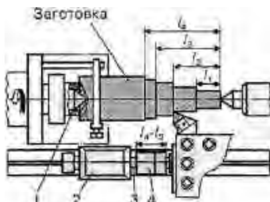
Рис. 2.25. СХЕМА НАЛАГОДЖУВАННЯ ВЕРСТАТА НА ОБТОЧУВАННЯ СХІДЧАСТОГО ВАЛА ПО УПОРУ
