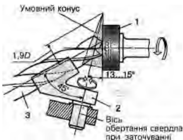
Рис. 3.6. СХЕМА ЗАТОЧУВАННЯ СВЕРДЛА НА СВЕРДЛОЗАТОЧУВАЛЬНОМУ ВЕРСТАТІ
