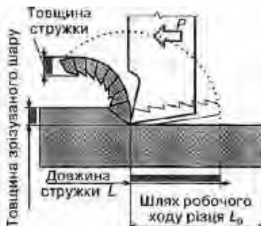
Рис. 6.3. СХЕМА УСАДКИ СТРУЖКИ
