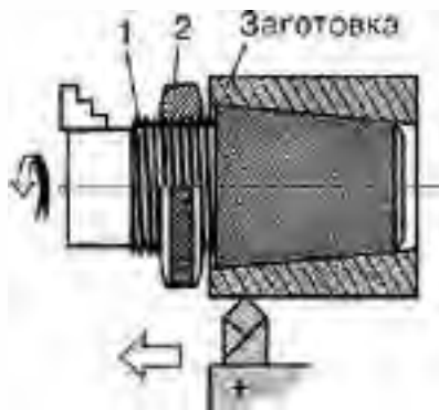
Рис. 13.6. Базування заготовки з конічним отвором на конусній оправці:
