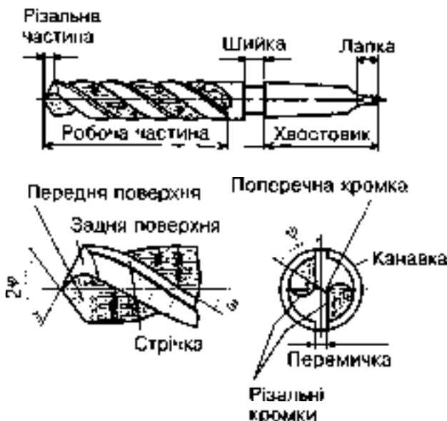
Рис. 3.4. ЧАСТИНИ Й ЕЛЕМЕНТИ СПІРАЛЬНОГО СВЕРДЛА:
