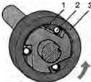
Рис. 10.19. ОБКІННА МУФТА 1 — корпус; 2 — ролик; 3 — обійма
