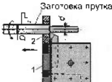
Рис. 12.13. ОБРОБКА НЕЖОРСТКОГО ВАЛА ІЗ ЗАСТОСУВАННЯМ ШПИНДЕЛЬНОГО ЦЕНТРА: 1 — шпиндель, 2 — втулка; 3 — гвинт, 4 — пали, 5 — поперечний центр «чашка»; 6 — зімнішайба; 7 — кулачок патрона
