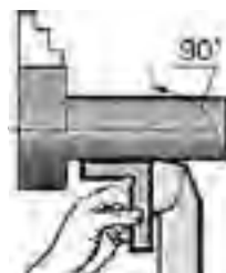
Рис. 1.26. Встановлення упорного різця за косинцем
