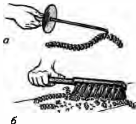
Рис. 1.43. ВИДАЛЕННЯ СТРУЖКИ З ВЕРСТАТА ЗА ДОПОМОГОЮ ГАЧКА (а) ТА ЩІТКИ (б)
