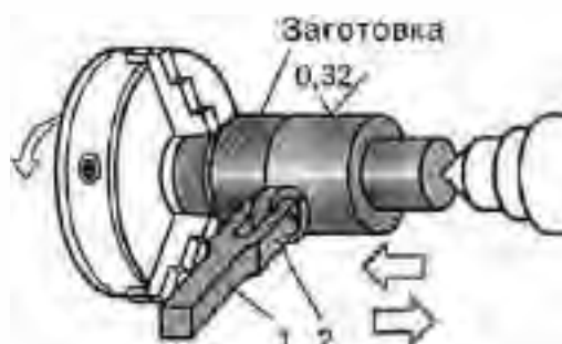
Рис. 9.7. ОБКАТУВАННЯ ЗОВНІШНЬОЇ ПОВЕРХНІ РОЛИКОМ
