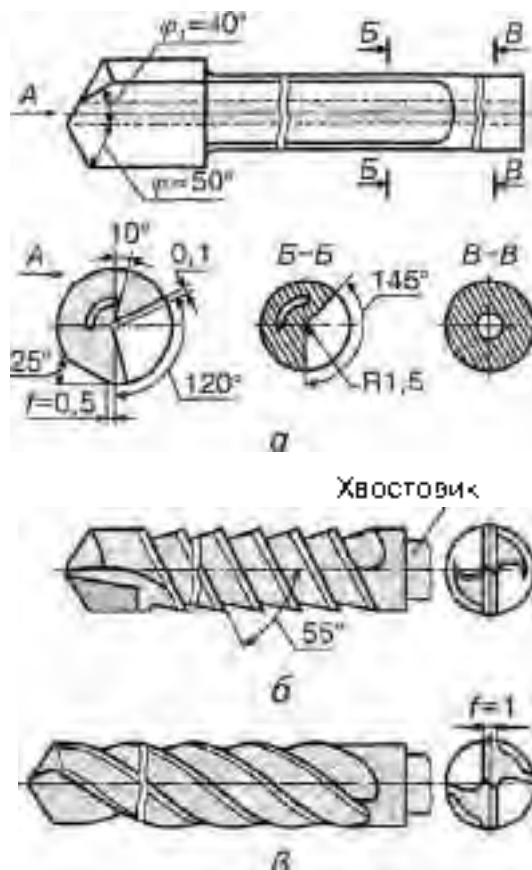
Рис. 3.17. СВЕРДЛА ДЛЯ ГЛИБОКОГО СВЕРДЛІННЯ
