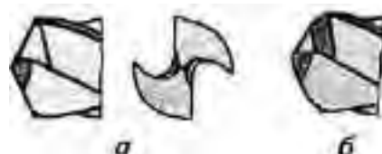
Рис. 3.8. ФОРМИ РАЦІОНАЛЬНОГО ПІДТОЧУВАННЯ СВЕРДЛА
