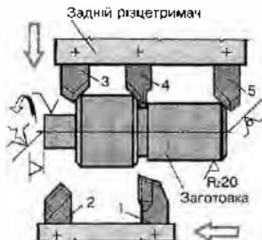
Рис. 14.15. БАГАТОРІЗЦЕВЕ НАЛАГОДЖЕННЯ ІЗ ЗАДНІМ РІЗЦЕТРИМАЧЕМ:
