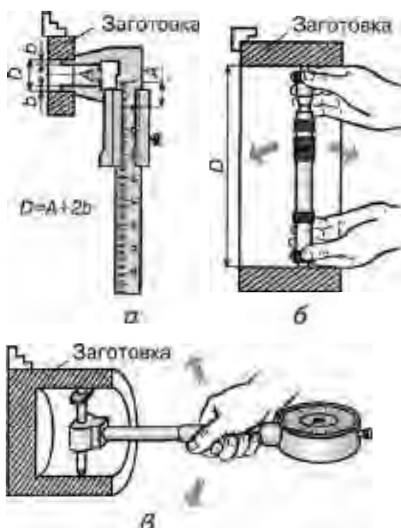
Рис. 3.2. СПОСОБИ КОНТРОЛЮ ДІАМЕТРА ОТВОРІВ ЗА ДОПОМОГОЮ
