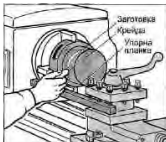
Рис. 12.2. ВИВІРЕННЯ ЗАГОТОВКИ «НА КРЕЙДУ» У ЧОТИРИКУЛАЧКОВИЙ ПАТРОНІ
