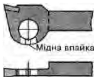
Рис. 5.24. ВІДРІЗНИЙ РІЗЕЦЬ З ВІБРОГАСИЛЬНОЮ ВПАЙКОЮ
