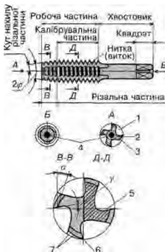
Рис. 4.14. ЧАСТИНИ Й ЕЛЕМЕНТИ МІТЧИКА.
