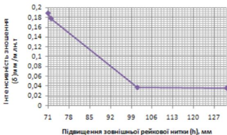
Рисунок 5.9 – Інтенсивність бічного зношення зовнішньої рейки за різної величини підвищення h [99]
