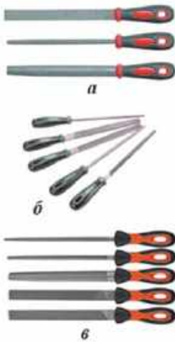
Рис. 1.5.3. Напилки: а — драчеві; б — лицьові; в — оксамитові
