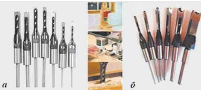
Рис. 5.4.1. Свердла для квадратних отворів (а), свердло-долото (б)
