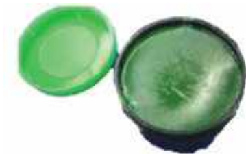
Рис. 1.10.8. Паста ГОІ використовується для доведення металевих, скляних і пластикових поверхонь
