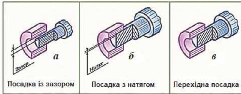
Рис. 3.2.6. Посадки: а — із зазором; б — з натягом; в — перехідна
