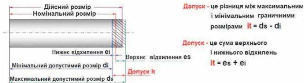
Рис. 3.2.3. Розміри деталі, відхилення та допуск
