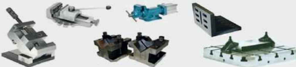
Рис. 1.6.3. Різновиди пристосувань для установки деталей при свердлінні
