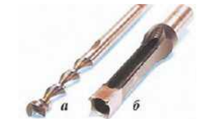
Рис. 5.4.3. Свердло (а) та просікач (б)
