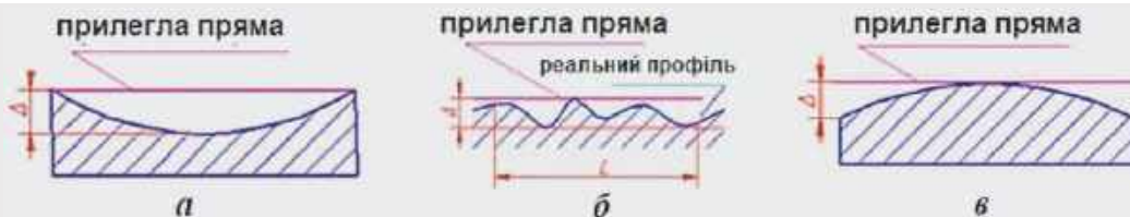
Рис. 3.3.3. Приклад відхилення: а — відхилення від прямолінійності у площині; б — увігнутість; в — опуклість
