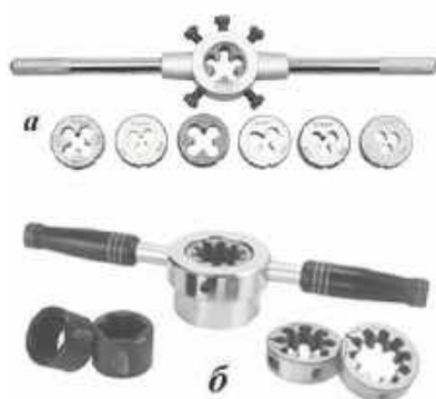
Рис. 1.7.11. Типи круглих плашок: а — цільні; б — розрізні
