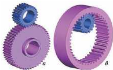
Рис. 2.2.4. Різновид зубчастих передач: а — зовнішнього зачеплення; б — внутрішнього зачеплення
