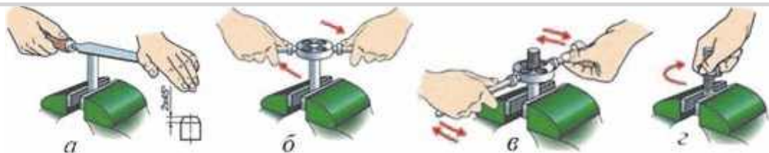
Рис. 1.7.12. Нарізування зовнішньої різьби: а — кріплення деталі та зняття фаски; б — встановлення плашки; в — нарізання різьби; г — контроль якості різьби
