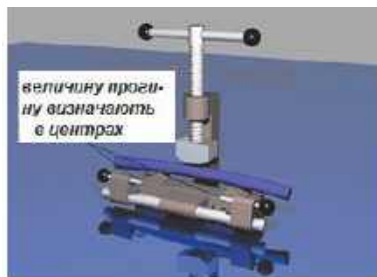
Рис. 1.3.5. Правка вала на ручному пресі
