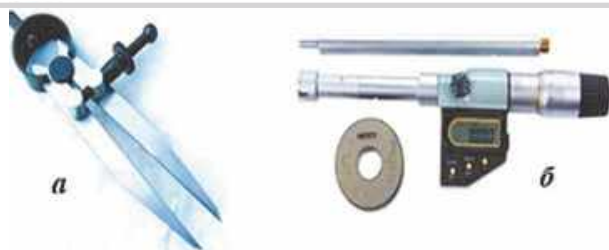
Рис. 3.5.3. Вимірювальний інструмент: а — кронциркуль; б — нутромір
