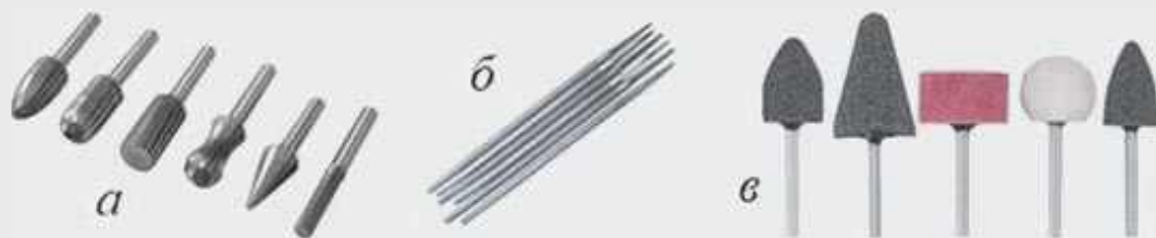
Рис. 1.5.12. Ріжучий інструмент: а — фрези-шарошки; б — круглі напилки; в — абразивні фасонні головки
