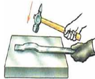
Рис. 1.3.3. Правка зігнутої металевої смуги
