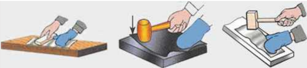
Рис. 1.3.1. Правка тонкого листового металу
