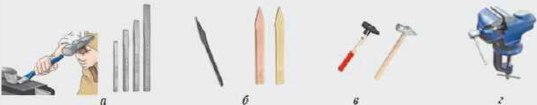
Рис. 1.2.1. Рубання металу та слюсарні інструменти, що застосовують під час рубання: а — зубило; б — крейцмейсель; в — слюсарні молотки; г — стулові лещата
