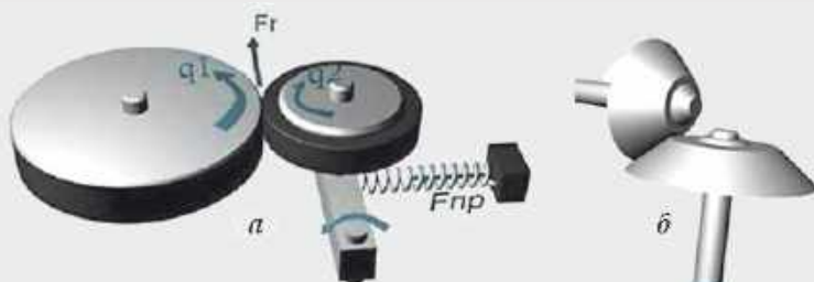
Рис. 2.2.7. Фрикційна передача: а — з паралельними валами; б — з пересічними валами
