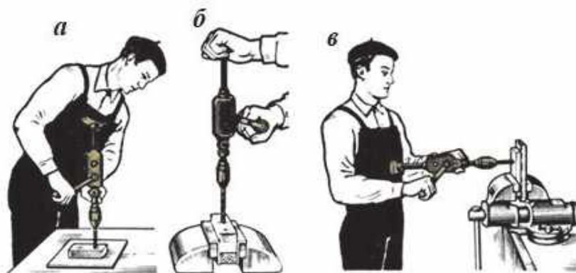
Рис. 1.6.6. Свердління ручним дрилем: а — на низькій підставці; б — на високій підставці в лещатах; в — у лещатах при горизонтальному положенні дреля
