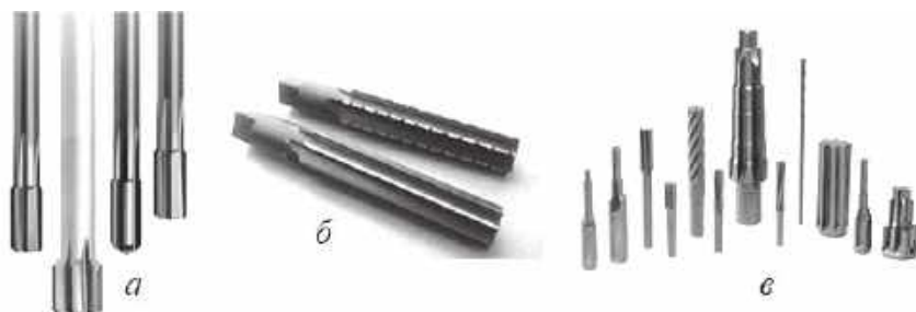
Рис. 1.6.10. Розгортки: а — циліндричні; б — конічні, в — сучасні ступінчасті.
