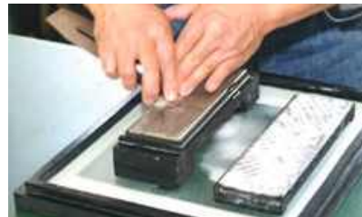
Рис. 1.10.5. Доведення леза рубанка на притирочних брускях
