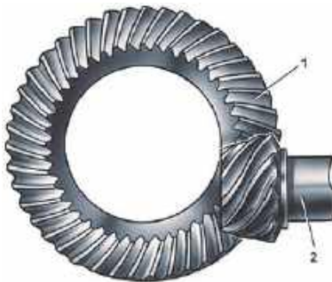
Рис. 2.2.6. Конічні гіпоїдні шестерні: 1 — ведена шестерня, 2 — тягова шестерня
