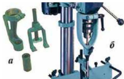
Рис. 5.4.4. Будова прес-тримача свердла з сорочкою-просікачем (а) та його кріплення на вертикально-свердильному верстаті (б)
