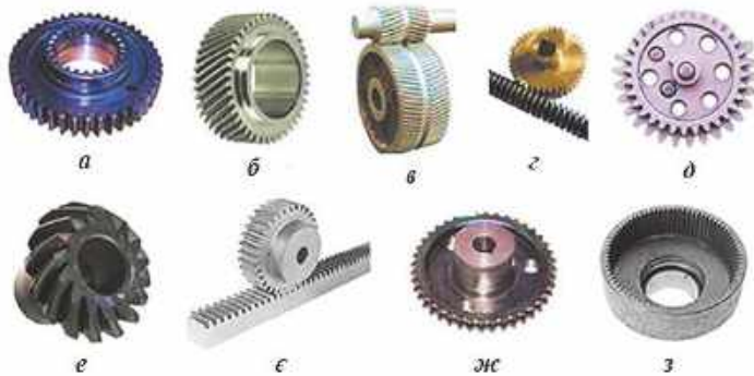
Рис. 2.2.5. Типи зубчатих шестерень: а — циліндрична прямозуба; б — циліндрична косозуба; в — шевронна; г — гвинтова черв'ячна; д — секторна; е — конічна; є — зубчаста рейка; ж — зірка; з — коронна
