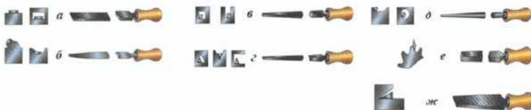
Рис. 1.5.1. Напилки за формою перетину (профілю): а — плоскі; б — напівкруглі; в — квадратні; г — тригранні; д — круглі; е — ромбічні; ж — ножові
