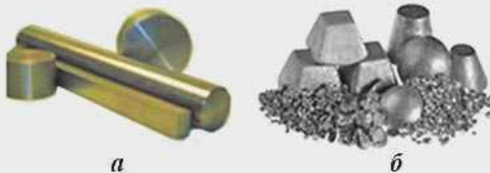
Рис. 4.2.1. Залізовуглецеві сплави: а — сталь; б — чавун
