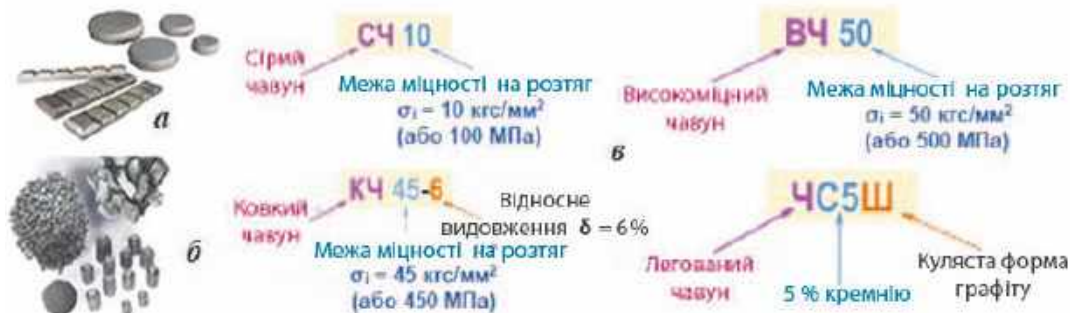
Рис. 4.2.2. Різновид чавуну: а — білий; б — сірий; в — приклад маркування чавунів
