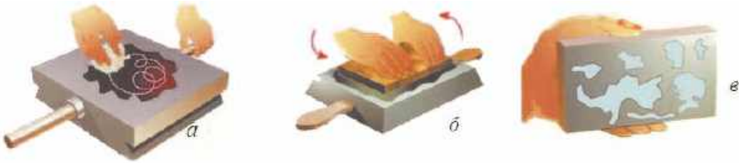
Рис. 1.10.12. Фарбування поверхні під час шабрування: а — фарбування плити тампоном; б — переміщення деталі по плиті; в — фарбована деталь.
