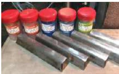
Рис. 1.10.7. Комплект для ручного притирання, що складається з чавунних притирів і алмазної пасту різної зернистості
