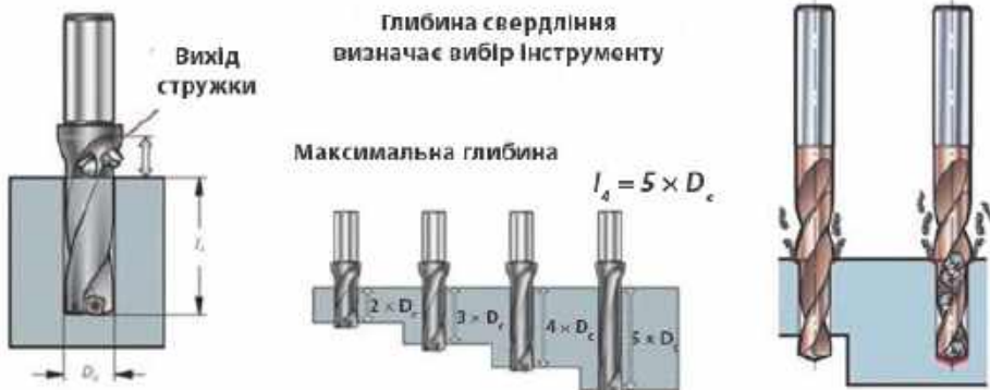
Рис. 1.6.8. Вибір інструменту при свердлінні на глибину
