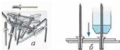
Рис. 1.8.13. Витяжні заклепки (а) та схема монтажу витяжної заклепки (б)
