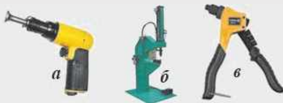
Рис. 1.8.12. Спеціальні клепальні інструменти: а — пневматичний клепальний молоток; б — електромеханічна клепальна машина; в — ручний заклепник
