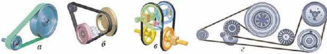
Рис. 2.2.13. Кількість валів, які охоплюються одним ременем: а — двовальна; б — тривальна; в — чотиривальна; г — багатовальна передачі
