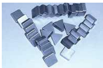
Рис. 4.4.4. Конструкційні мінералокерамічні матеріали (пластини різального інструментарію)
