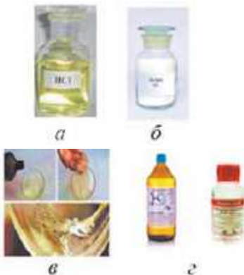
Рис. 1.9.5. Різновиди флюсів: а — соляна кислота; б — хлористий цинк; в — рідке скло; г — плавикова кислота
