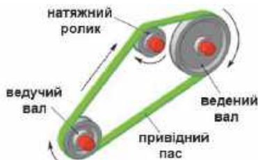
Рис. 2.2.14. Ремінна передача з використанням натяжних пристроїв
