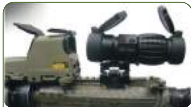
Іл. 20.16. Поєднання коліматора (ліворуч) та магніфікатора (праворуч) на одній Пікатіні
