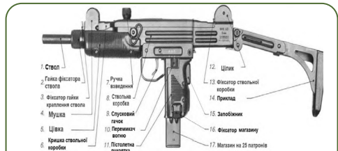
Іл. 19.17. Основні частини пістолета-кулемета UZI.
