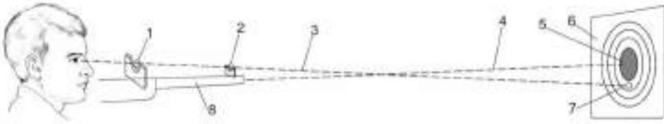
Іл. 25.5 Схема прицілювання в разі перевищення середньої точки прицілювання: 1 — середина прорізу прицілу; 2 — верхній край мушки; 3 — лінія прицілювання; 4 — середня траєкторія кулі; 5 — середня точка влучення — центр мішені; 6 — мішень; 7 — точка прицілювання; 8 — ствол гвинтівки
