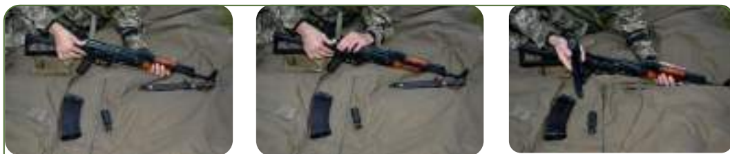
Іл. 22.6. Відокремлення кришки ствольної коробки
