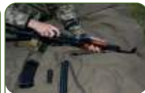
Іл. 23.8. Відокремлення затворної рами із затвором
