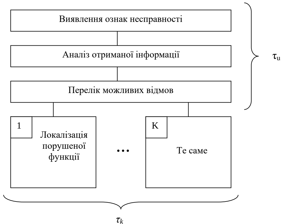
Рис. 1.52. Методика перевірки пристроїв системи автоматики
