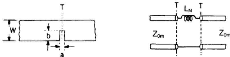
Рис.3.46 Еквівалентна схема поперечної щілини у мікросмушкової лінії передачі
