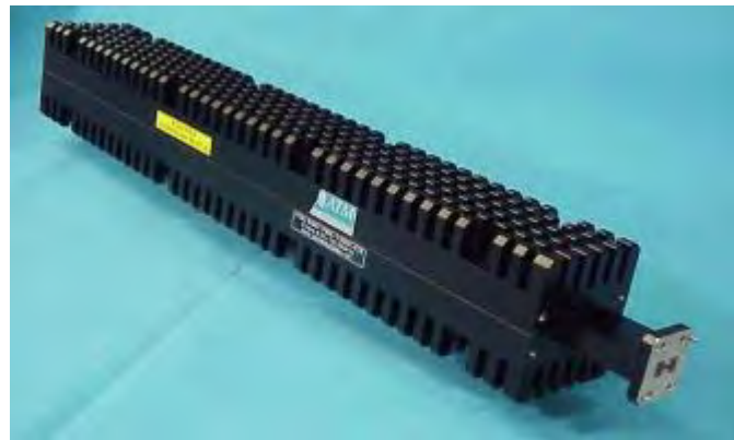
Рис.3.3 Зовнішній вигляд хвилевідних узгоджених навантажень на велику потужність
