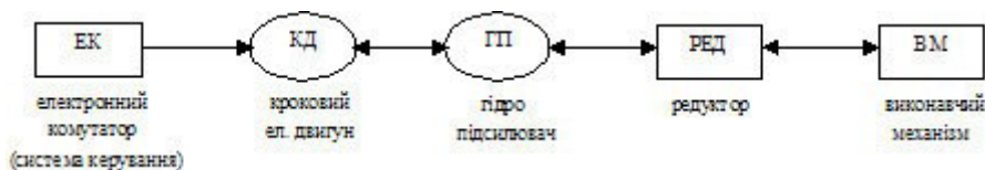
Рис. 6.3. Схема електрогідравлічного приводу.
