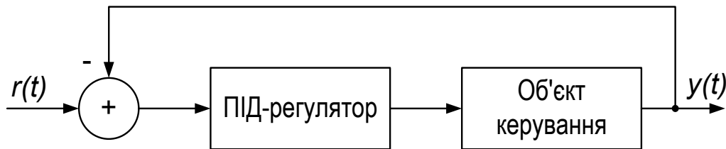
Рис. 2.11. Структура системи із застосуванням ПІД-регулятора
