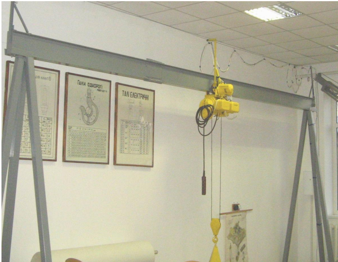
Рис. 1. Зовнішній вигляд фізичної моделі крана
