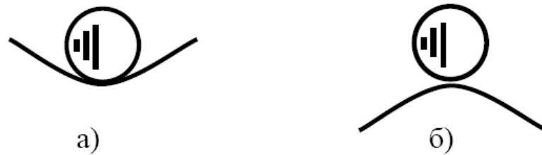
Рис. 2.8. Ілюстрація поняття стійкості системи: а) – система стійка (куля повертається в початкове положення, після закінчення дії сили, що змістила її із цього положення); б) – система нестійка (після дії сили куля не повертається у початкове положення)
