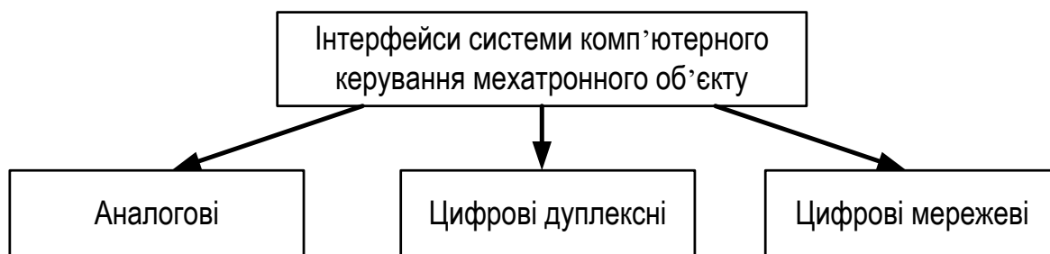
Рис. 3.9. Типи інтерфейсів системи комп'ютерного керування мехатронного об'єкта
