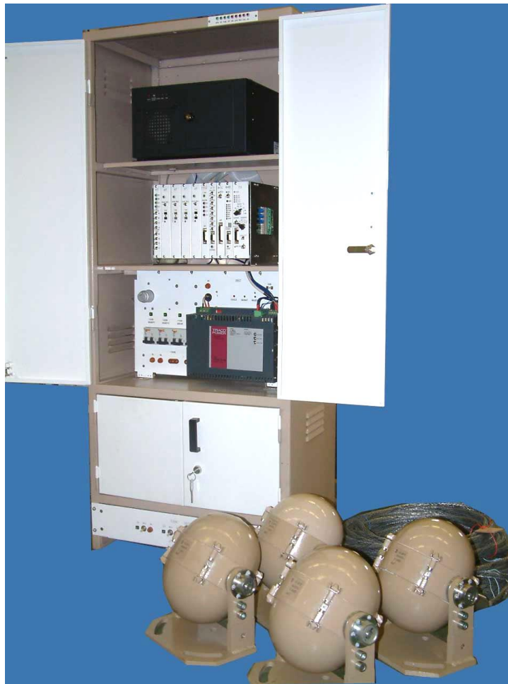
Рисунок 7 – Зовнішній вигляд стійки управління перегінним обладнанням
