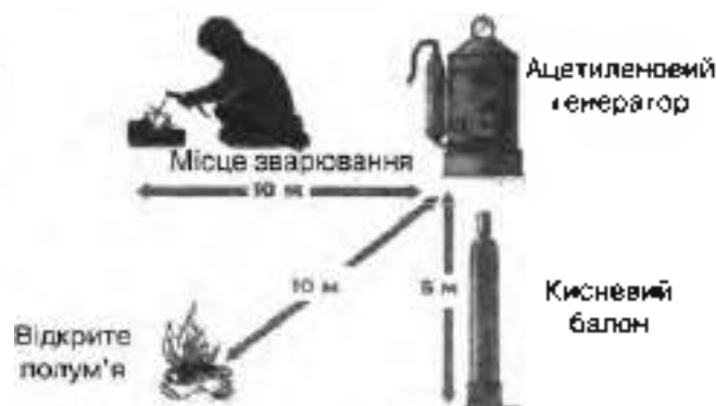
Рис. 66. Розташування газового обладнання
