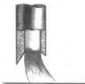
Рис. 9. Несиметричність обмазки електрода
