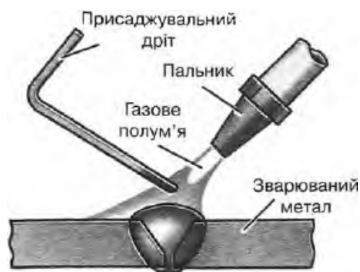
Рис. 86. Розміщення пальника і присадки
