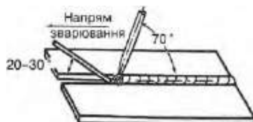
Рис. 109. Зварювання з подачею присаджувального матеріалу в дугу
