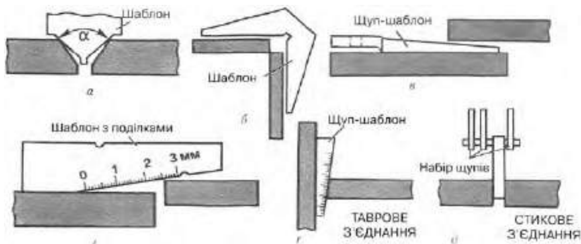
Рис. 32. Контроль точності складання.
