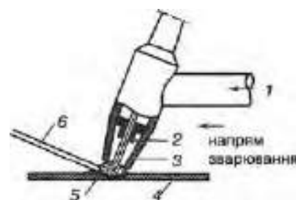
Рис. 97. Схема зварювання неплавким електродом.
