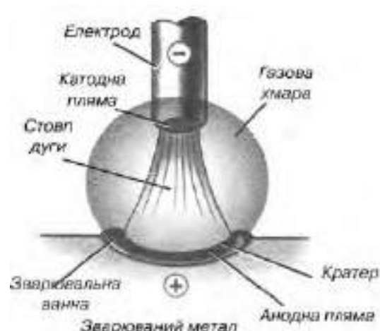
Рис. 4. Схеми горіння (а) та процеси, що відбуваються (б)
