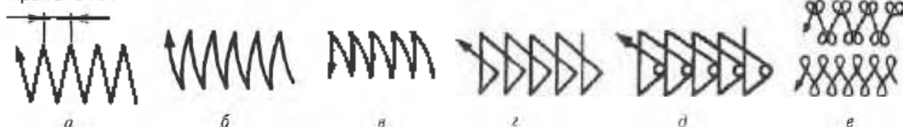
Рис. 42. Види коливальних (поперечних) рухів кінця електрода:
