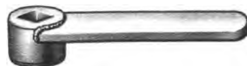
Рис. 64. Спеціальний ключ для кріплення редуктора і відкриття вентилів ацетиленового балона
