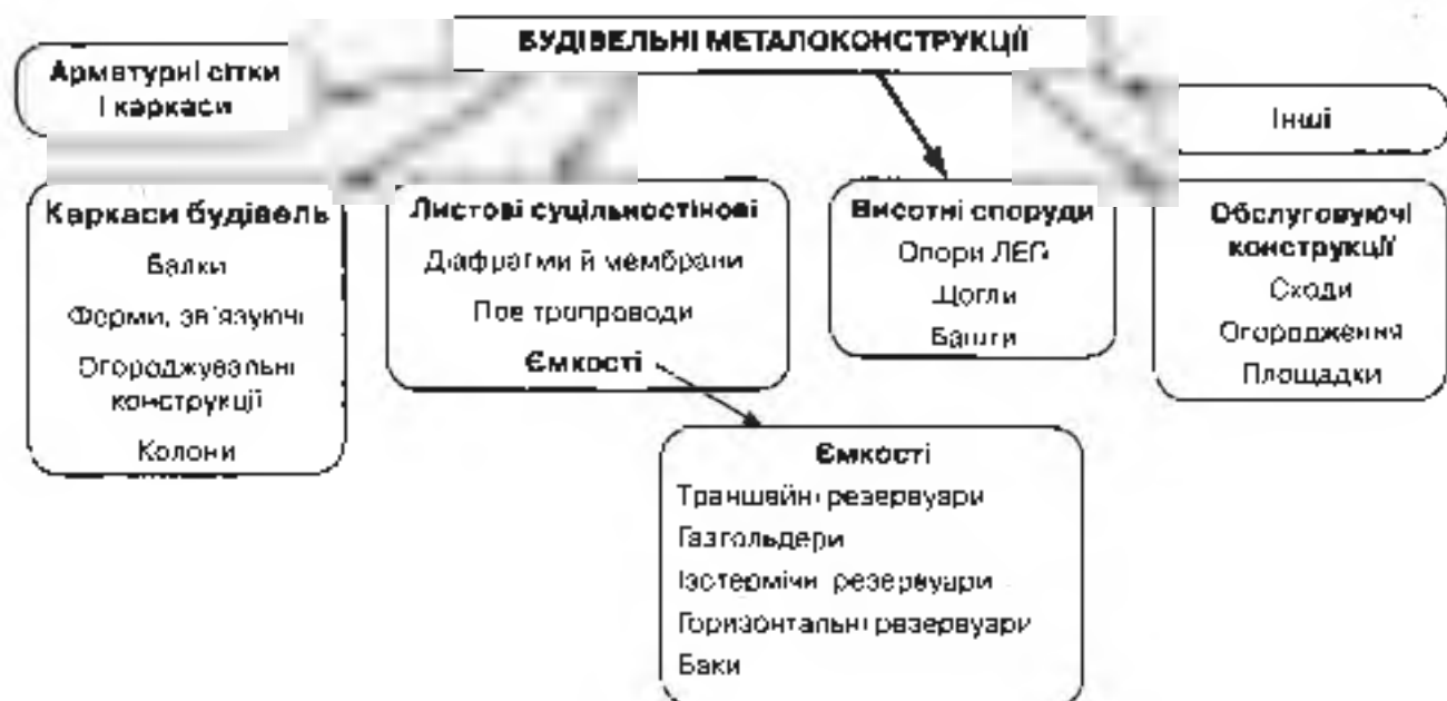
Рис. 121. Класифікація будівельних зварних конструкцій
