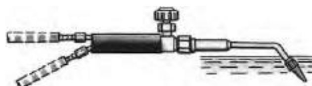
Рис. 75. Перевірка на газонепроникність
