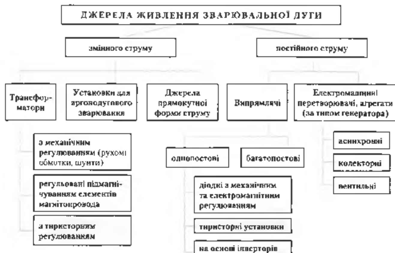
Рис. 15. Джерела живлення зварювальної дуги
