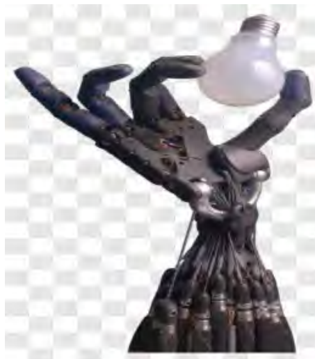
Рис. 9.6. Робот «людська» рука з датчиком тиску
