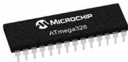
Рис. 7.9. Зовнішній вид МК AVR типу ATmega328
