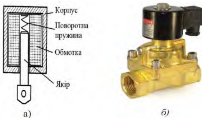
Рис. 6.11. Зображення електромагнітного виконавчого пристрою: а – схема; б – зовнішній вигляд
