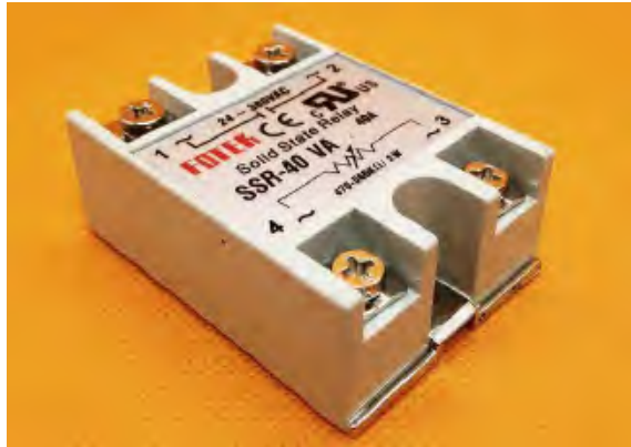
Рис. 5.8. Зображення зовнішнього вигляду твердотільного реле
