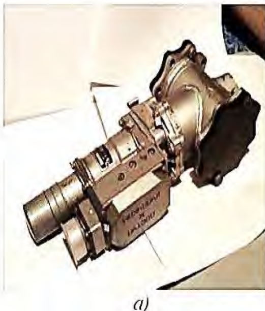
Рис. 6.3. Зовнішній вигляд і схемне зображення виконавчого механізму МПК-13А-5
