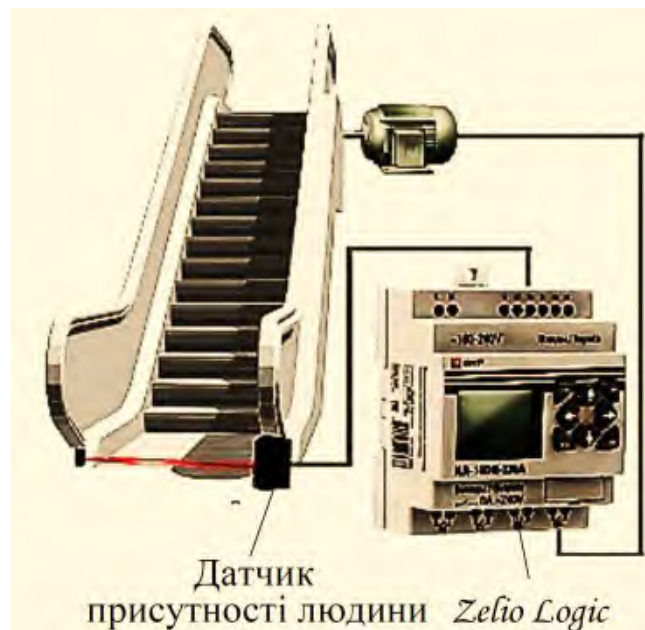
Рис. 5.10. Зображення використання програмованого реле для керування роботою ескалатора
