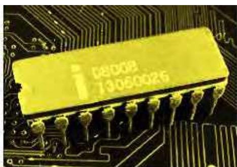
Рис. 7.2. Зовнішній вид 8-розрядного однокристального мікропроцесора Intel 8008 і КР580ВМ80А
