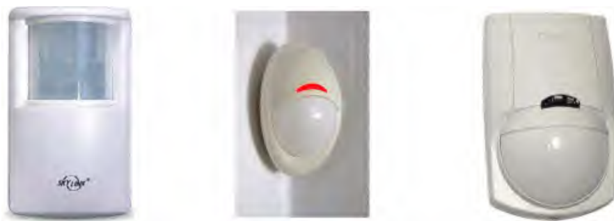
Рис. 2.31. Види деяких типів датчиків руху
