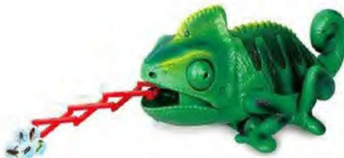
Рис. 8.7. Захват, принцип дії якого запозичений з язика хамелеона
