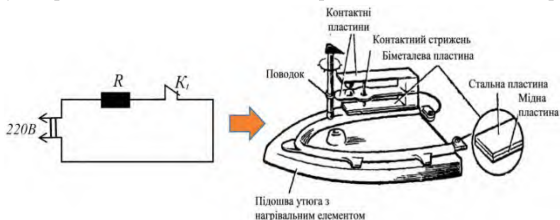
Рис. 2.34. Схема регулювання температури нагріву з біметалевим термоконтрактом
