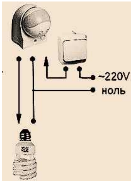
Рис. 2.32. Монтажна схема включення датчика руху для автоматичного вмикання лампи
