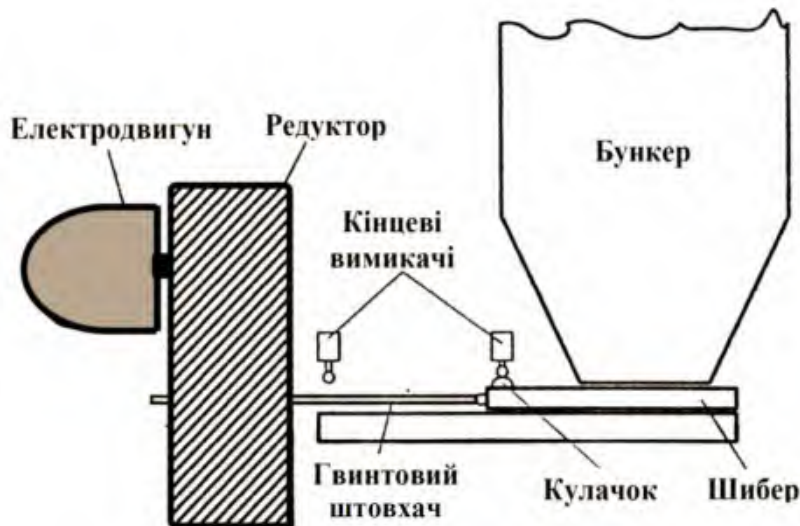
Рис. 6.8. Схема керування бункером-накопичувачем з використанням виконавчого механізму шиберної заслінки
