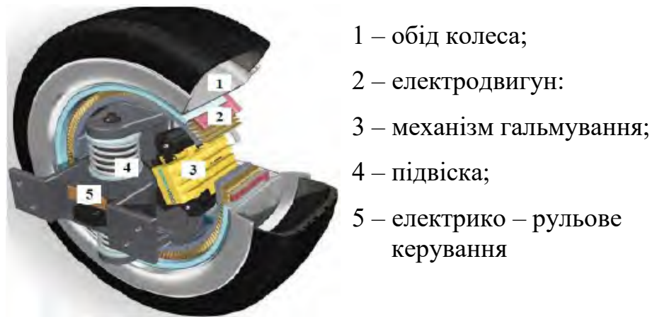
Рис. 10.6. Мотор-колесо
