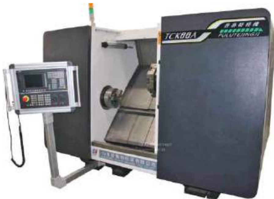
Рис. 1. Токарний верстат з програмним керуванням з похилою станиною
