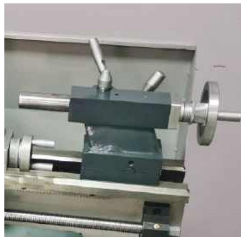
Рис. 15. Верстат токарний настільний ТЕХНОРЕАЛ 180х300V-M, оснащений швидкозажимною задньою бабкою, хід пінолі 60 мм
