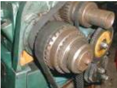
Рис. 3.10. Привідні паси на токарному верстаті
