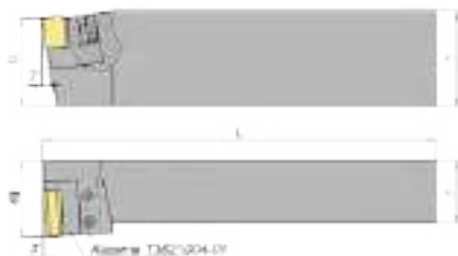
Рис. 7.45. Різець прохідний з віброзміцненою пластиною
