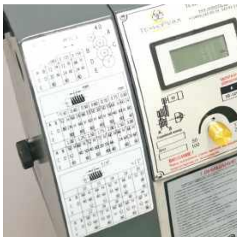
Рис. 14. Таблиця метричних і дюймових різьб верстата токарного настільного ТЕХНОРЕАЛ 180х300V-M
