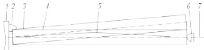
Рис. 3.2. Схема деформації заготовки довгого вала під час її кріплення на токарному верстаті: 1 — патрон; 2 — кулачки; 3 — заготовка; 4 — деформована заготовка; 5 — вісь у зігнутому положенні; 6 — задній центр; 7 — задня бабка
