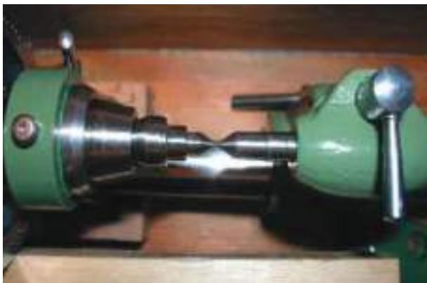
Рис. 11. Збіг конусів переднього і заднього центрів
