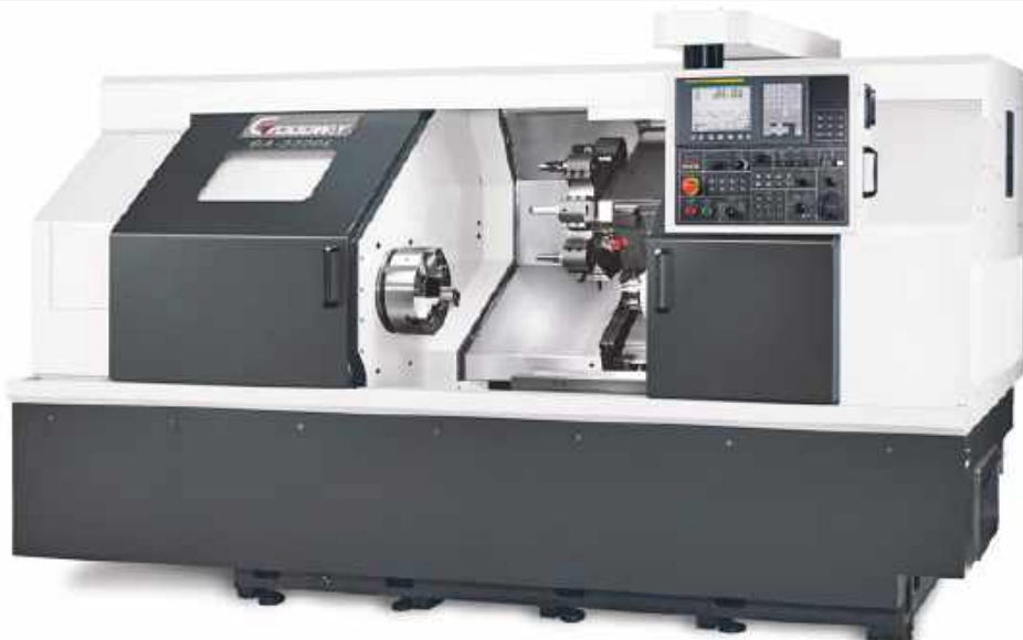
Рис. 7.18. Токарно-револьверний верстат з програмним керуванням з 12-позиційною револьверною головкою
