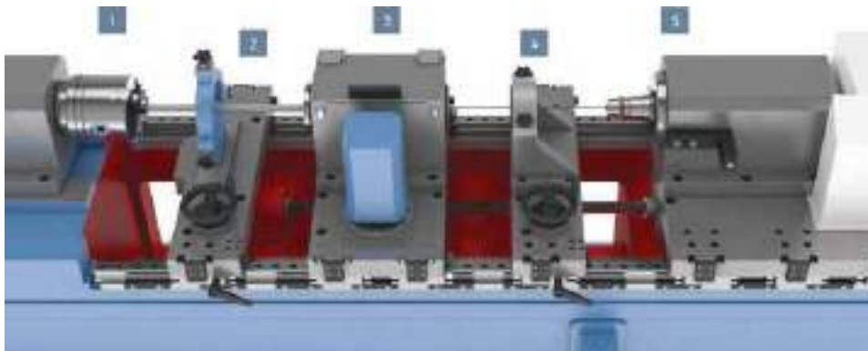
Рис. 8. Основні елементи верстата для глибокого свердління: 1 — шпиндель; 2 — люнет для заготовки; 3 — мастилоприймальник; 4 — люнет для підтримки різального інструмента; 5 — задня бабка
