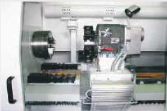
Рис. 7.34. Робоча зона верстата для обробки графіту та інших пилоутворювальних матеріалів
