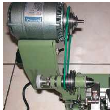
Рис. 12. Передача обертання від двигуна до шпинделя годинникового верстата
