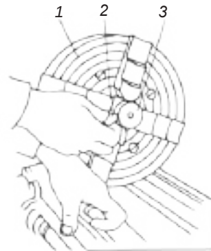
Рис. 2.5. Закріплення та вивірка заготовки за допомогою крейди: 1 — кільцеві риси; 2 — крейда; 3 — заготовка;
