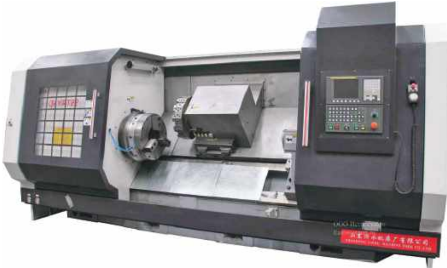
Рис. 2. Токарний трубонарізний верстат з похилою станиною
