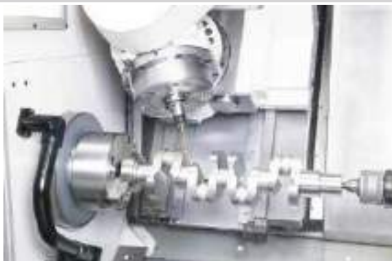
Рис. 6.10. Свердління отвору на шийці ексцентрикової деталі
