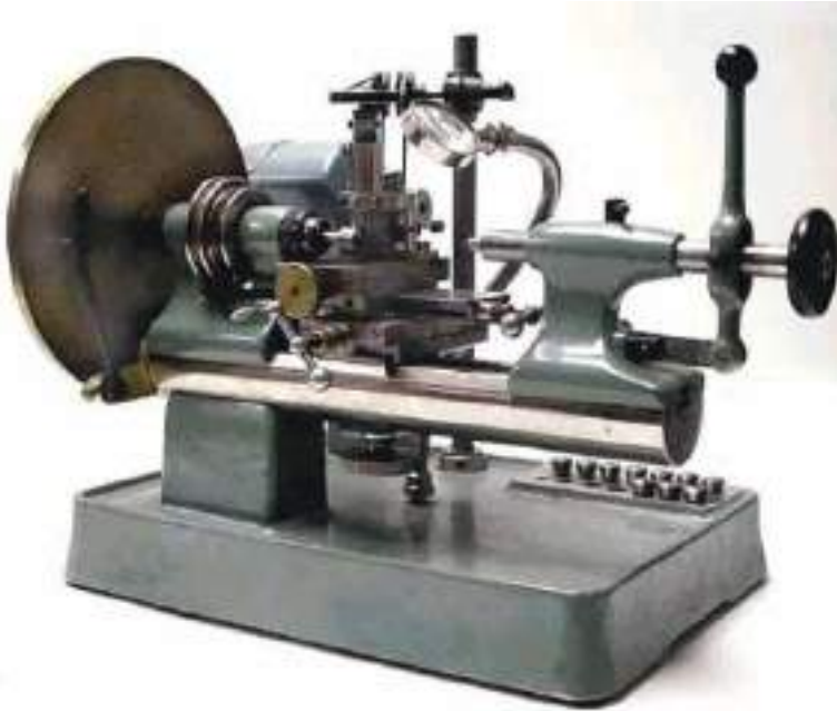
Рис. 10. Годинниковий токарний верстат Gem Glorious
