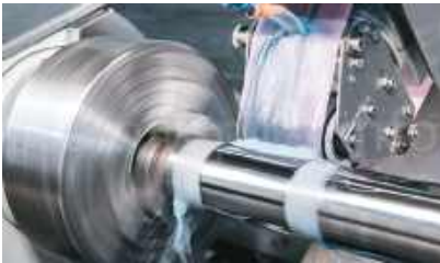
Рис. 1.1. Отримання гладкої поверхні суперфінішуванням
