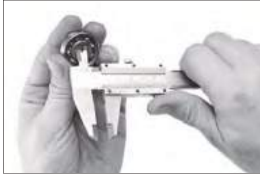
Рис. 4.21. Вимірювання отворів штангенциркулем ШЦ-I
