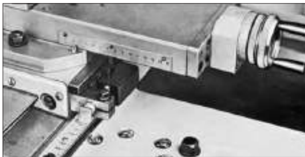
Рис. 3.27. Використання поперечного упора
