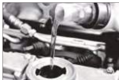
Рис. 2.1. Змащування вузлів токарного верстата
