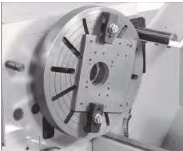
Рис. 2.5.2. Кріплення деталі на планшайбі
