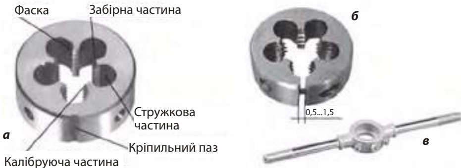
Рис. 5.15. Види плашок: а – суцільна; б – розрізна; в – плашкотримач
