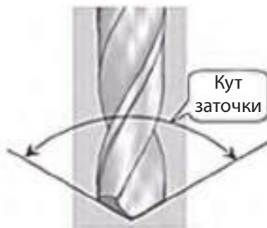
Рис. 4.7. Кут заточки свердла
