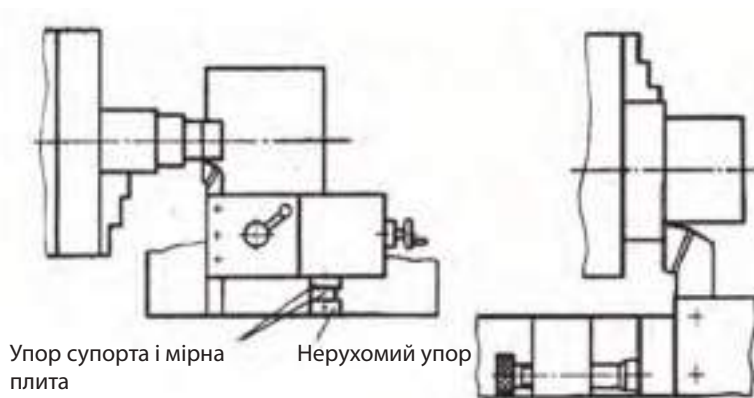
Рис. 3.24. Схеми обробки заготовок з використанням упорів
