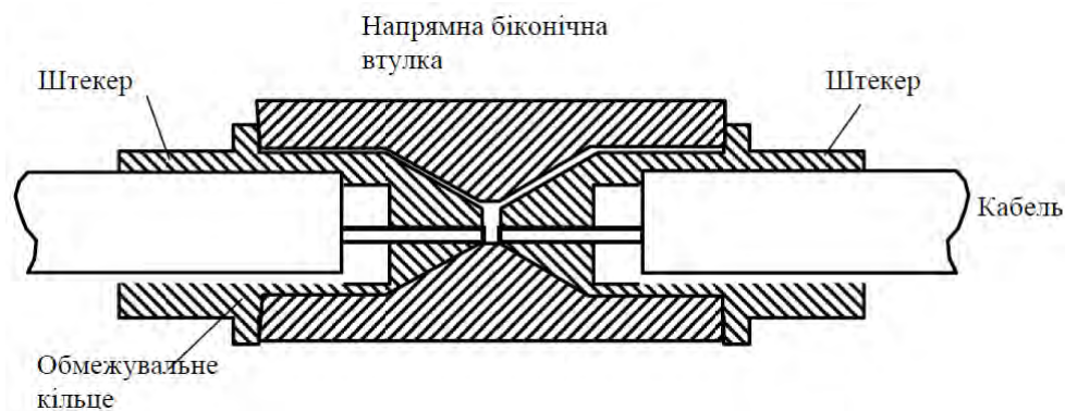
Рисунок 4.21 – Розріз конструкції з'єднувача з конічною втулкою
