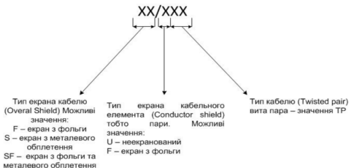
Рисунок 6.3 – Повне маркування кабелів вита пара
