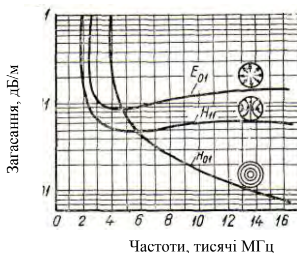
Рисунок 3.16 – Частотні залежності коефіцієнта затухання хвилеводу для хвиль різних типів
