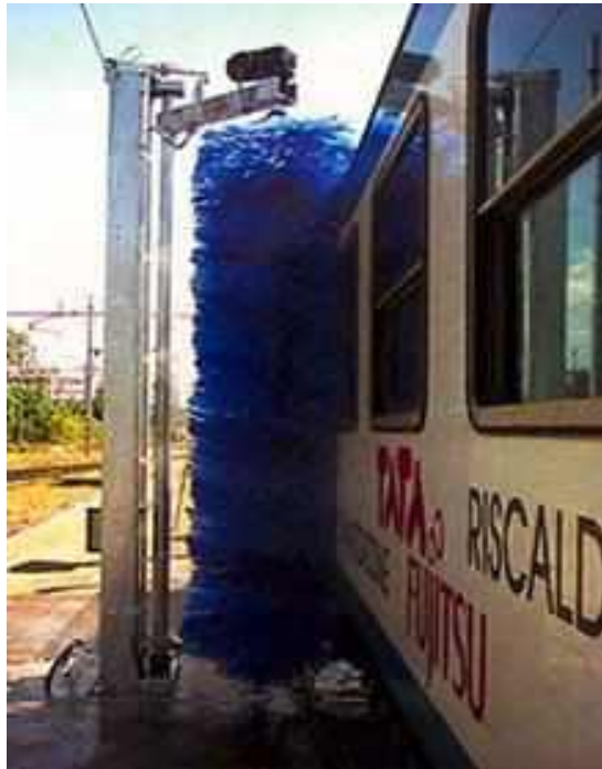
Рис. 5.13. Бічна вертикальна щітка мийної установки
