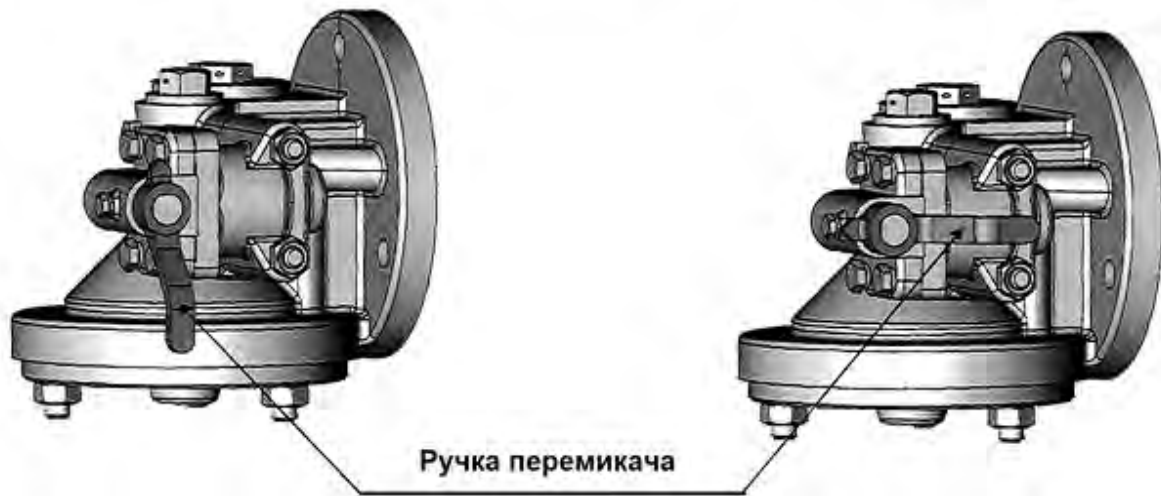
Рисунок 4.3 — Положення ручки перемикача режимів роботи повітророзподільника № 242
