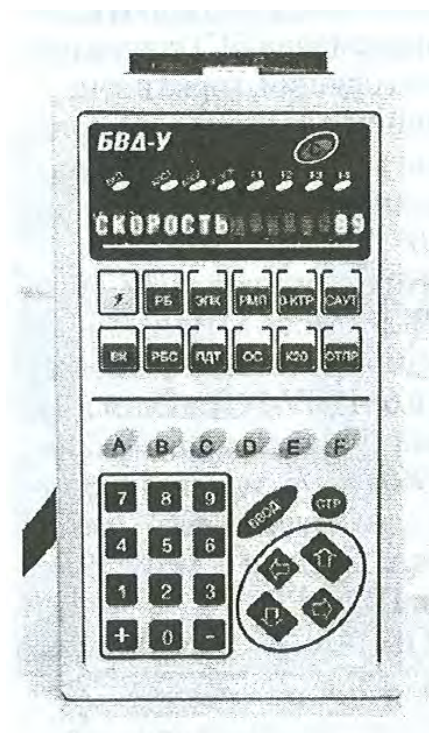
Рисунок 5.7 — Блок введення даних передрейсового контролю БВД-У
