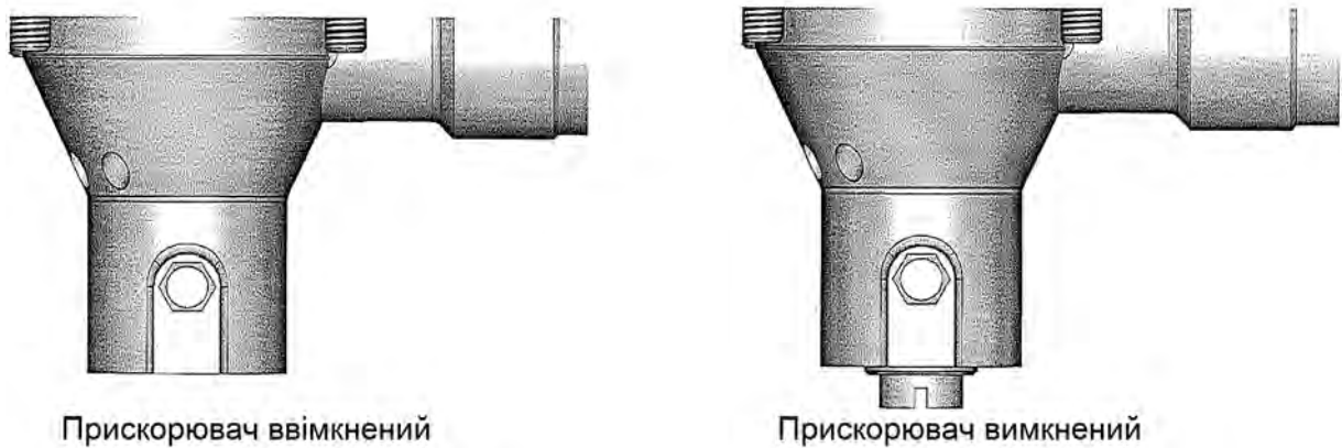
Рисунок 4.6 — Положення упорки перемикача прискорювача екстреного гальмування повітророзподільника № 242-1
