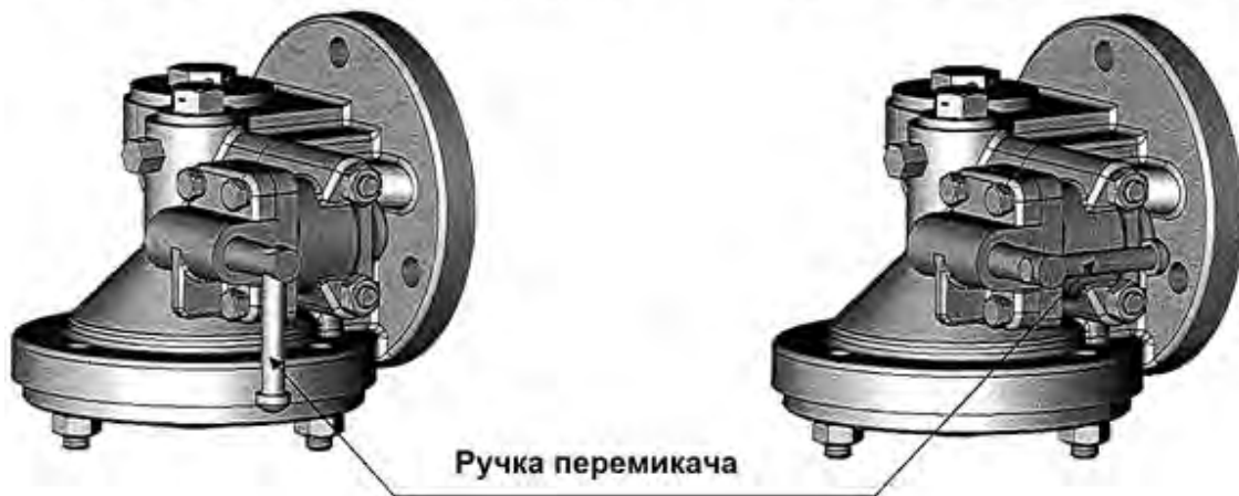
Рисунок 4.4 — Положення ручки перемикача режимів роботи повітророзподільника № 242-1
