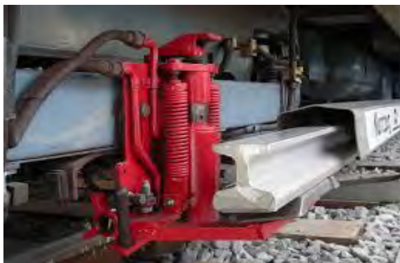
Рисунок 6.20 – Струмознімач вагону та кінцеве відведення контактної рейки: 1 – кронштейн для кріплення контактної рейки; 2 – контактна рейка; 3 – нахил робочої поверхні; 4 – ізолятор
