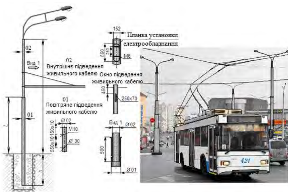
Рисунок 6.3 – Елементи конструкції опор контактної мережі тролейбуса
