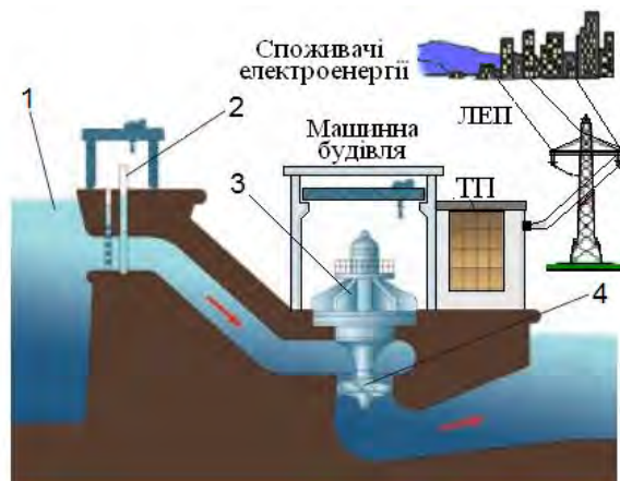
Рисунок 1.3 – Гідроелектростанція та процес виробництва електричної енергії: 1 – водосховище; 2 – отвір; 3 – гідрогенератор; 4 – гідравлічна турбіна; ТП – трансформаторна підстанція
