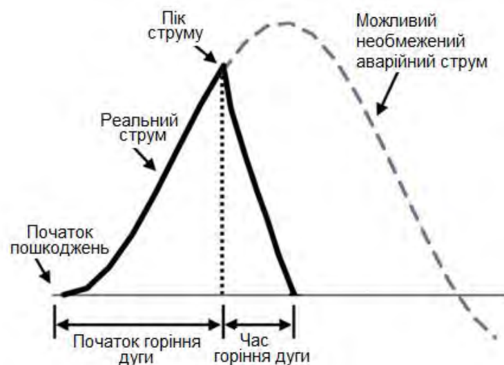
Рисунок 7.23 – Струмообмежувальний ефект запобіжника
