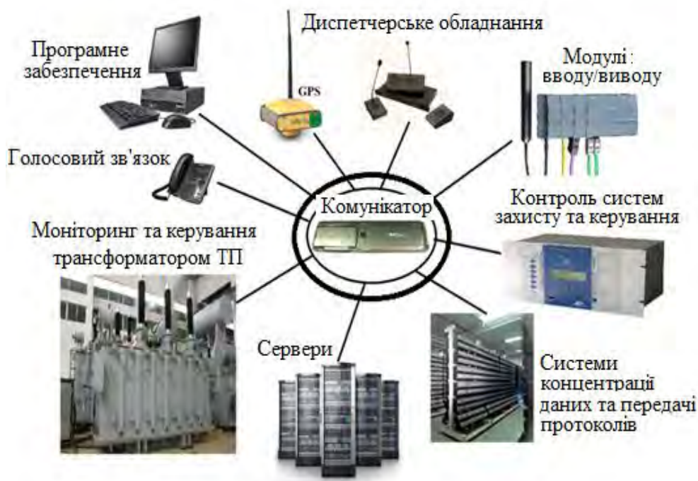
Рисунок 2.5 – Структура телемеханічної системи
