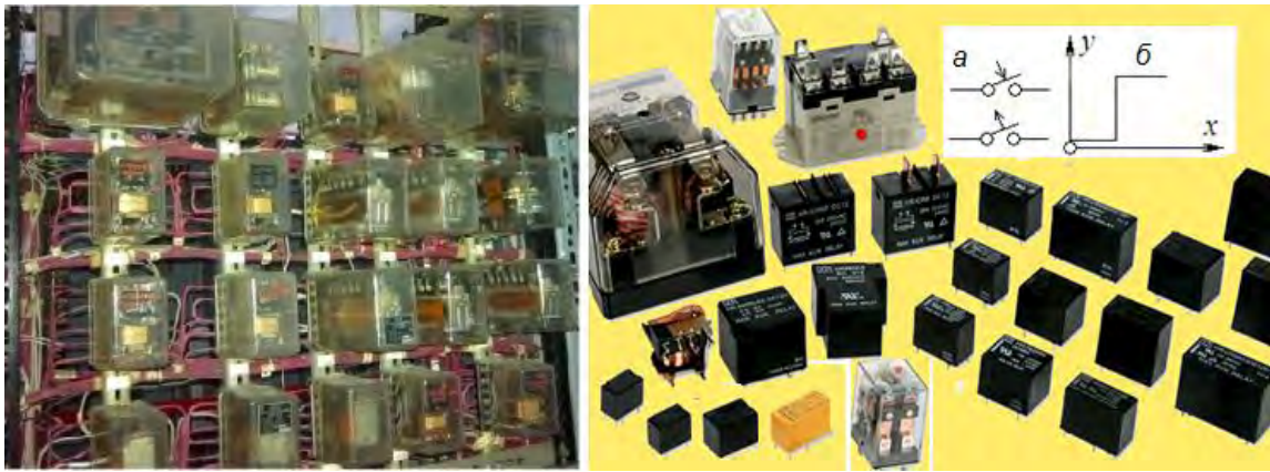
Рисунок 7.14 – Загальний вигляд реле та особливості їхньої роботи
