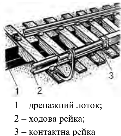
Рисунок 6.17 – Схема проходження тягового струму по ділянці та загальний вигляд контактної рейки
