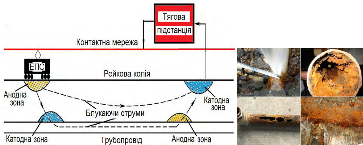
Рисунок 3.9 – Розподіл блукаючих струмів та їх наслідки
