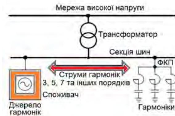
Рисунок 3.12 – Розташування ФКП на лінії електропередачі
