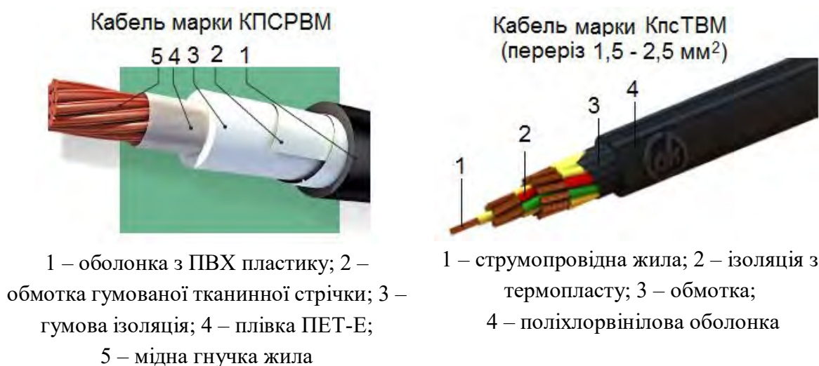
Рисунок 2.12 – Конструкції кабелів живильних ліній
