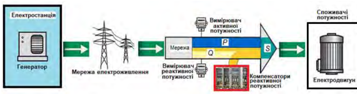
Рисунок 3.10 – Розподіл потужності в системі електропостачання
