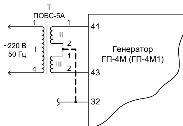
Рисунок 13.1 – Схема підключення живлення ГП-4М (ГП-4М1)
