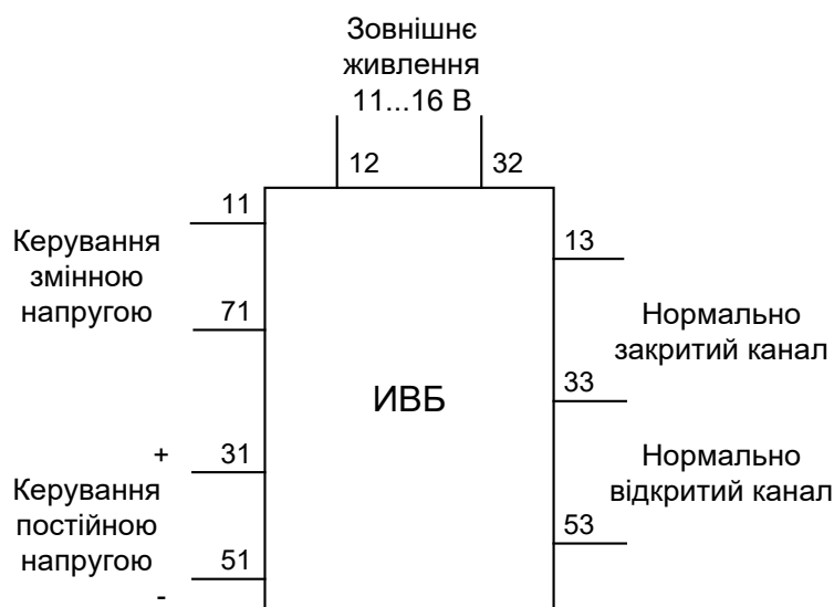
Рисунок 9.7 – Схема підключення реле ИВБ
