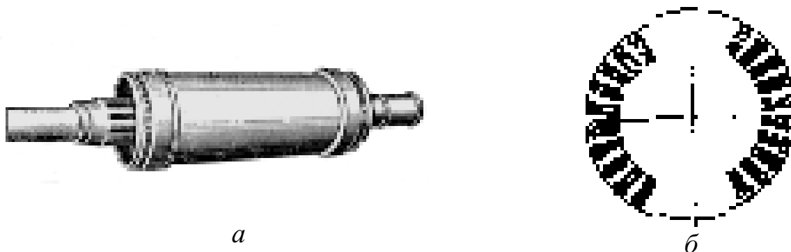
Рис. 37.7. Загальний вигляд ротора турбогенератора –а та поперечний розріз ротора –б
