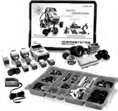
Рис. 30. Конструктор Lego Mindstorms EV3 Балки – використовуються як каркаси конструкцій.
