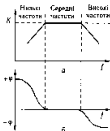
Рис. 1.11. АЧХ (а) і ФЧХ (б) ВС підсилювача
