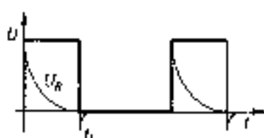
Рис. 13.22. Вихідна напруга фіксатора нульового рівня позитивних імпульсів
