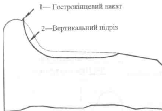
Внижж 13.11 — Гострокінцевий накат та вертикальний підріз гребеня.
