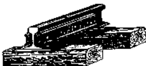
Рис. 2.72. Двоголова уніфікована накладка на рейковому стикі з чотириболтовим кріпленням
