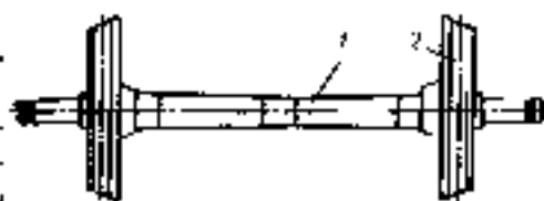
Рис. 3.28. Вигляд колісної пари. 1 – вісь; 2 – колесо.
