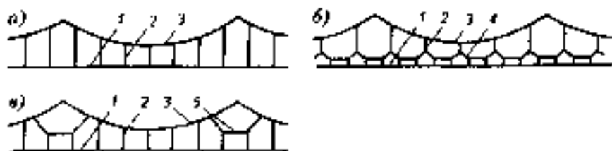
Рис. 5.18. Ланцюгові контактні підвіски — одинарна (а), подвійна (б) і одинарна з ресором (в): 1 — контактний провід; 2 — струна; 3 — несучий трос; 4 — димпінгний пружид; 5 — ресорний трос.
