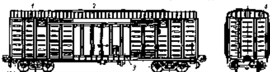
Рис. 3.60. Кузов універсального чотирьохосового критого вагона об'ємом кузова 120 м 3 : 1 – бокова стіна; 2 – дах; 3 – двері; 4 – торцева стіна.
