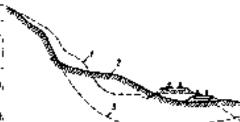
Рис. 2.45. Зсув і осідання на хвилюванні (осідання і зміщення): 1 - нормальний профіль; 2 - зміщення і осідання ґрунту; 3 - площа зсуву.
