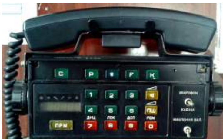
Рисунок 21 - Конструкція передньої панелі пульта керування радіостанції
