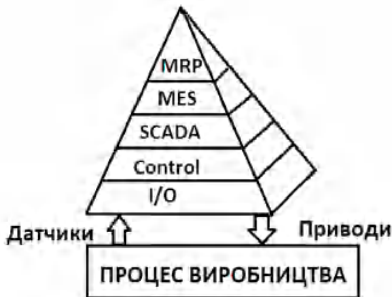
Рисунок 1.5. Рівні автоматизації комп'ютерно-інтегрованого виробництва
