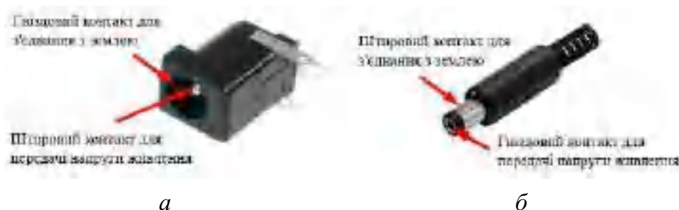
Рис. 7.1. Частина з'єднувача для підключення живлення до плати: а – роз'єм живлення для монтажу на плату DS-210, б – штекер для монтажу на проводі
