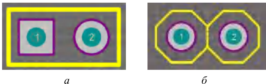
Рис. 7.10. Посадкове місце PLS коннекторів: а – посадкове місце із вбудованої бібліотеки Miscellaneous Connectors , б – один із варіантів власного посадкового місця
