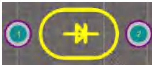
Рис. 3.19. Посадкове місце для діоду в корпусі DO-41
