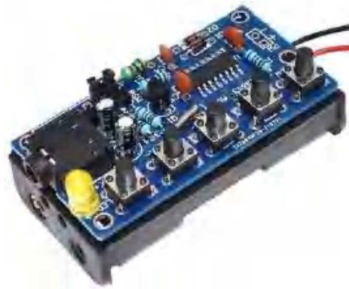
Рис. Л.26. Зовнішній вигляд FM приймача: зверху – плата, знизу – тримач для двох батарейок (акумуляторів) типу АА
