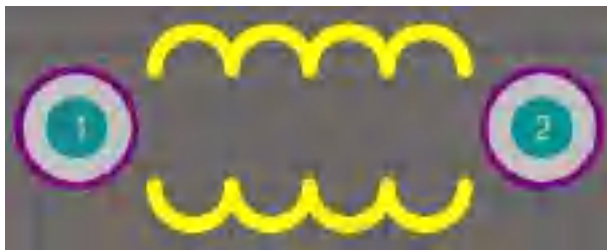
Рис. 2.26. Посадкове місце котушки індуктивності герметичної (КІГ), діапазон індуктивностей якої лежить в межах 1-500 мкГн
