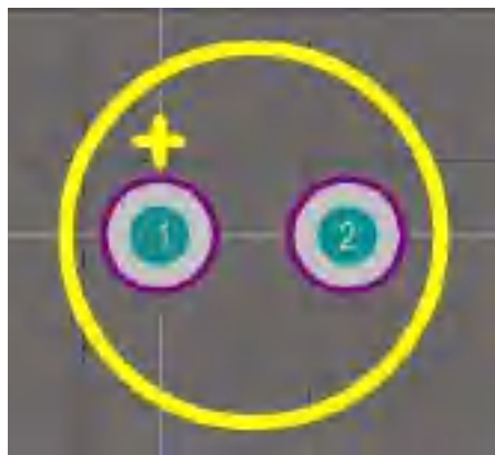
Рис. 2.25. Посадкове місце електролітичного конденсатору Hitano ECR
