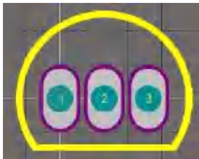
Рис. 3.20. Посадкове місце для біполярного транзистора в корпусі SOT-54
