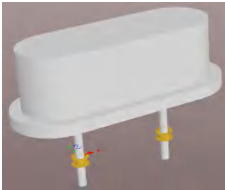
Рис. Л.7. Остаточний вигляд корпусу кварцевого резонатору, створений засобами Altium Designer
