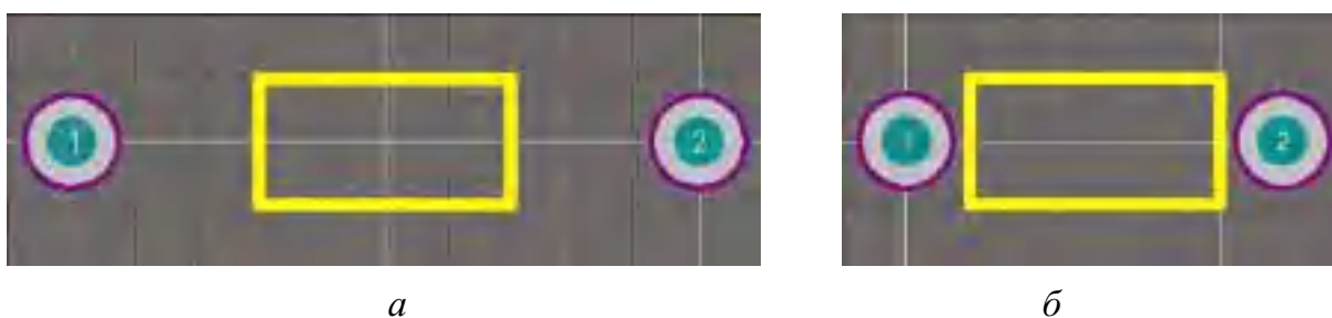
Рис. 2.21. Посадкове місце постійного резистору: a – MF 0,25, б – MF 0,125
